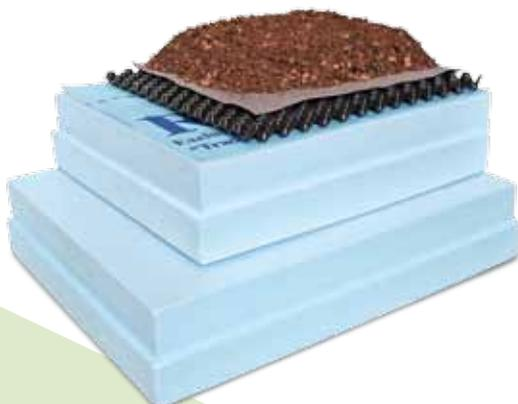
Auf Umkehrdächern dürfen oberhalb der XPS-Wärmedämmplatten keine Schichten aufgebracht werden, die das Ausdiffundieren von Feuchtigkeit verhindern. Deshalb ist die Speicherschutzmatte durch das diffusionsoffene Trenn- und Gleitvlies TGV 21 zu ersetzen und Wurzelschutzfolien sind – falls notwendig – direkt auf der Abdichtung, also unter den Wärmedämmplatten zu verlegen. Die fehlende Wasserspeicherung der Speicherschutzmatte wird durch eine höhere Substratschicht kompensiert.
